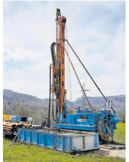
Mobile Salzbohrtürme bohren rund 300 Meter tief.
